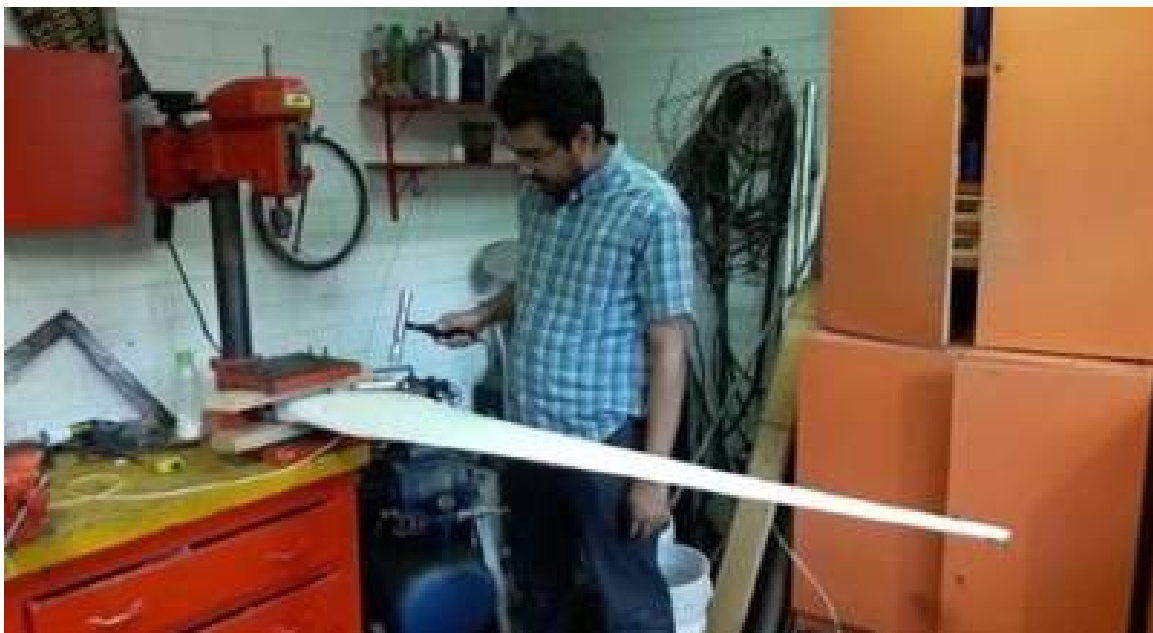
Figura 3.12. Prueba de análisis modal en condición respuesta forzada.
