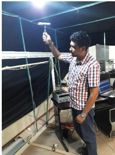
Figura 5.15. Prueba de análisis modal en la post-experimentación.
