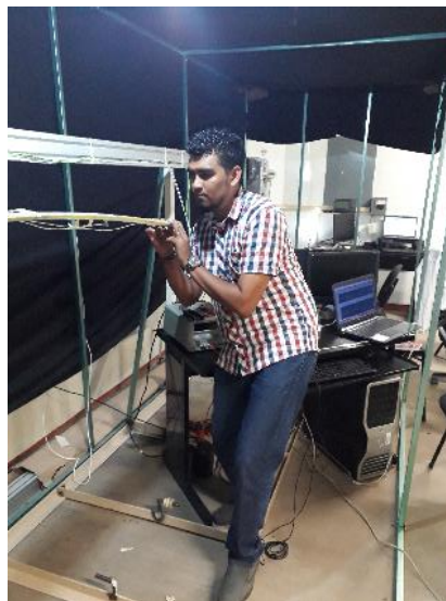
Figura 5.13. Prueba de análisis modal en la pre-experimentación.
