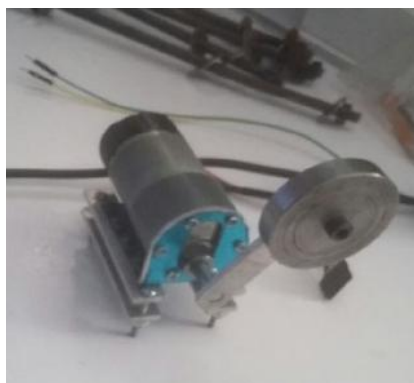
Figura 4.1. Motor DC con excéntrica modificada.
