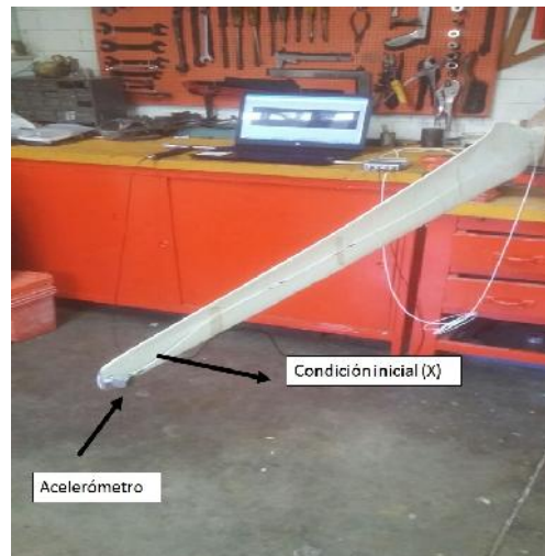
Figura 3.5. Prueba de análisis modal en condición de respuesta libre.
